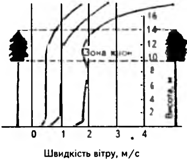
Рис. 3.13. Вертикальний розподіл вітру у хвойному лісі як функція його швидкості на відкритому місці.
