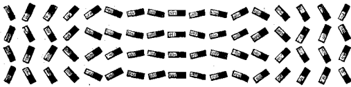
Старое воззрѣніе на молекулярное строенїе магнитовъ. Вверху тѣло ненамагниченное, внизу — намагниченное. См. текстъ, стр. 284.
