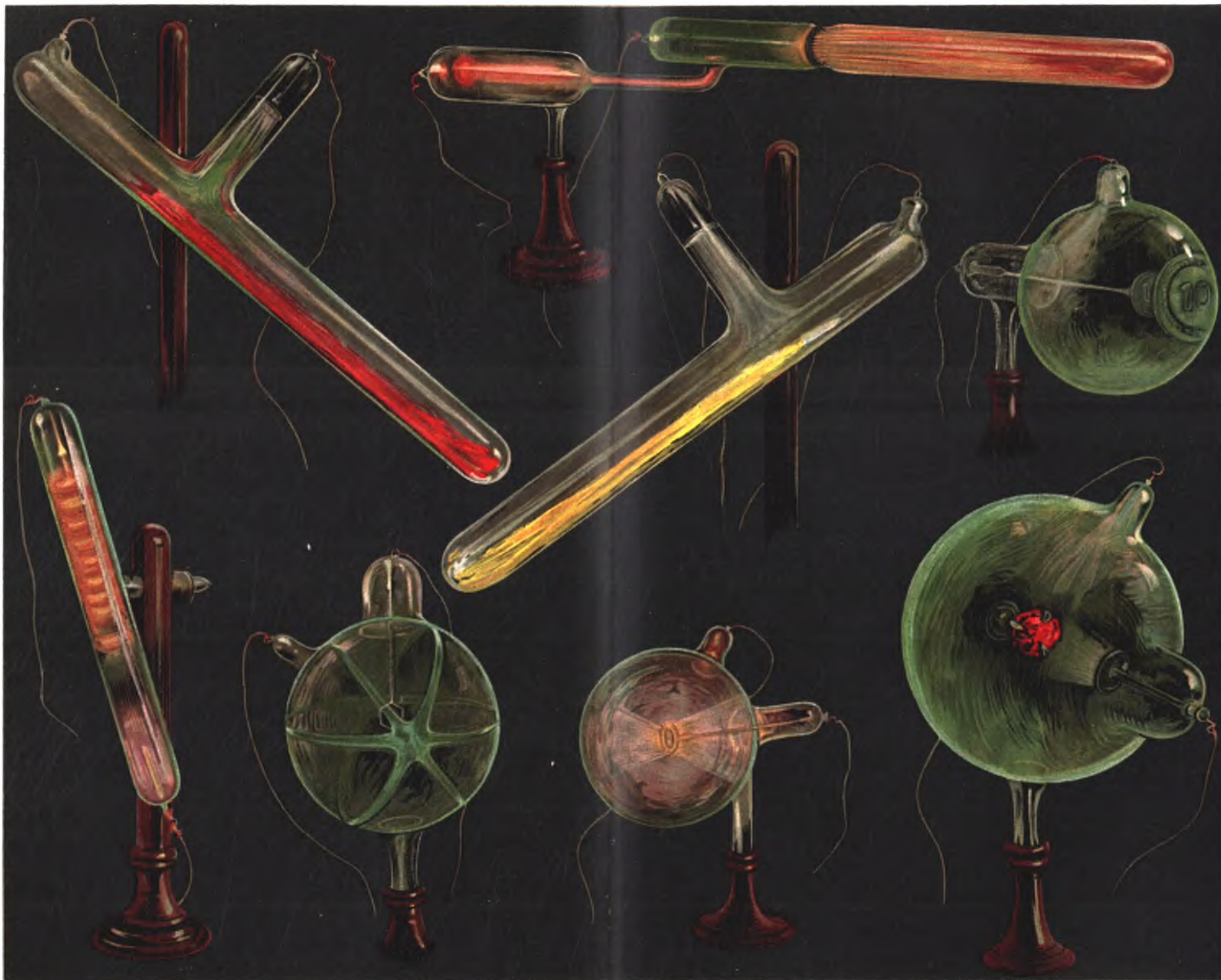
Свѣтотыя явленія электрическаго разряда въ разрѣженныхъ газахъ. (Гейслеровы и Гольдштейновскія трубки.)
