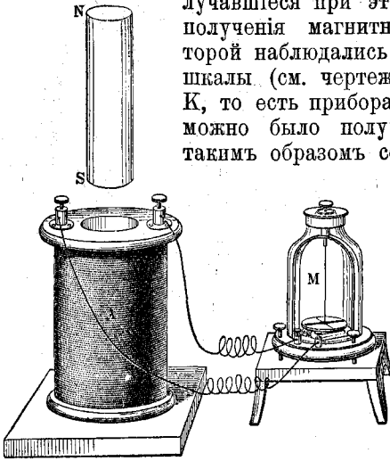
Наведеніе тока магнитомъ. M гальванометръ; A мультипликаторъ; NS магнитъ. См. текстъ, стр. 336.
