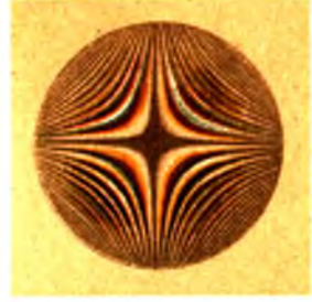
3. Двѣ пластинки, параллельныя оси, накрестъ, гиперболы.
