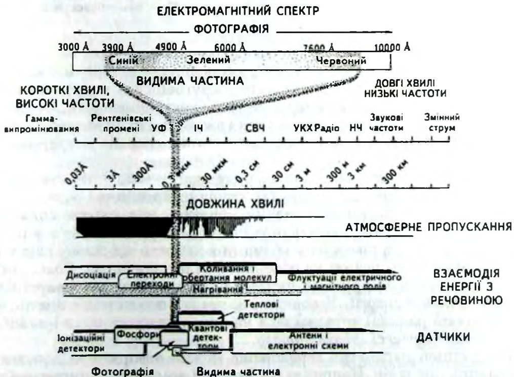
Рис. 6.5. Електромагнітний спектр і його видима частина, методи виявлення хвиль різної довжини (частоти). А (Ангстрем) = 0,1 нанометра (нм) = 0,0001 мікрометра (мкм).
