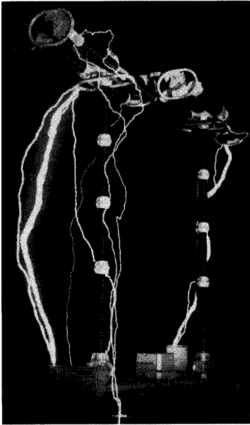
Isolationstest an einem Leistungsschalter für Hochspannung
