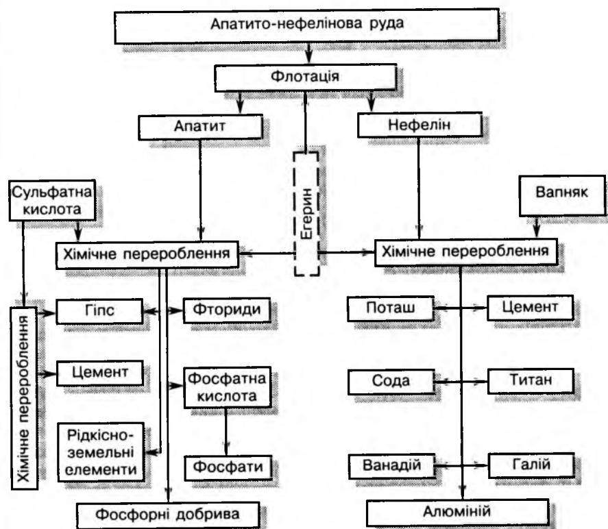
Схема комплексного використання апатито-нефелінової руди
