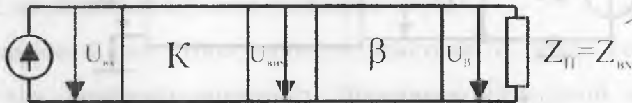
Рис. 2. Еквівалентна схема розімкненого тракту RC-генератора.
