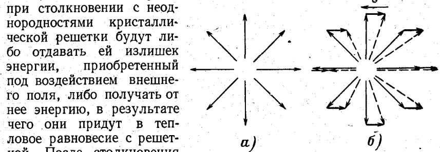
Рис. 1-7. Схематическое изображение скоростей электронов проводимости при отсутствии (а) и наличии (б) электрического поля.
