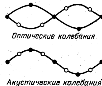
Рис. 4-10. Схематическое изображение колебаний частиц в двухатомной линейной решетке, иллюстрирующее природу различия между оптическими и акустическими колебаниями. Предполагается, что колебания поперечные и что длина волны обоих типов колебаний одинакова.
