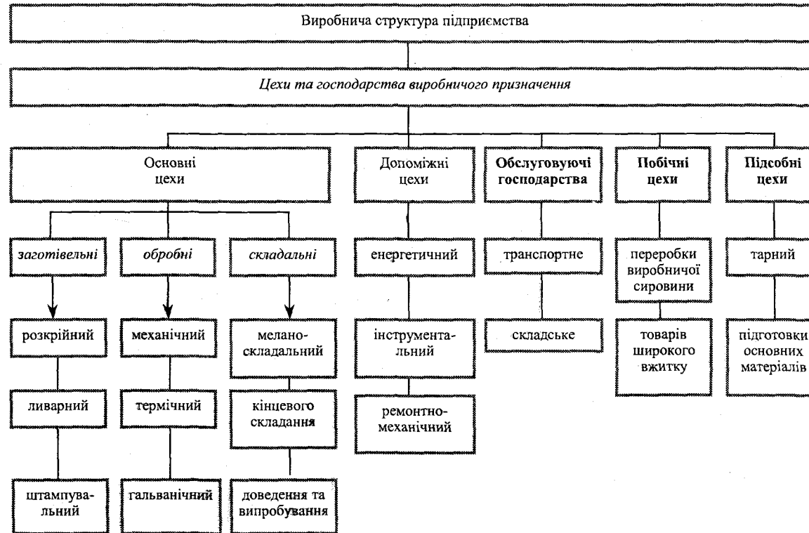
Рис. 1.6. Схема виробничої структури машинобудівного підприємства
