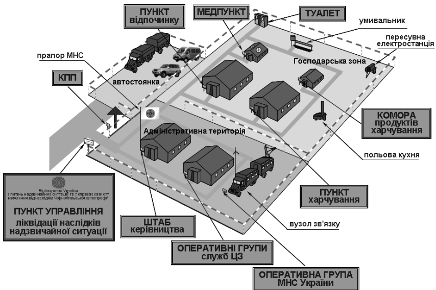
Рис. 2.3. Схема обладнання пересувного пункту управління
