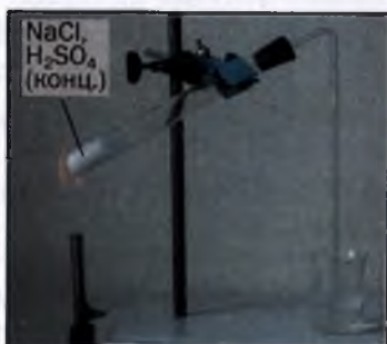
Мал. 23. Добування гідроген хлориду і хлоридної кислоти в лабораторії
