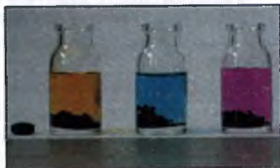
Мал. 16. Початок досліду з виявлення поглинальної здатності активованого вугілля
