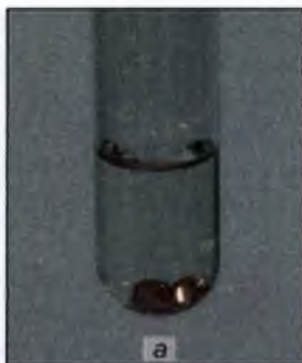
Мал. 45. Відношення міді до сульфатної кислоти: а — розбавленої; б — концентрованої
