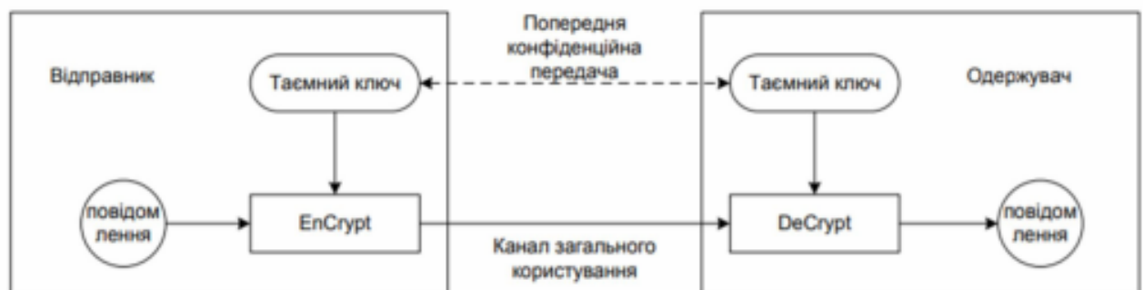
Рисунок 1.1 – Схема процесу передачі інформації повідомлення
