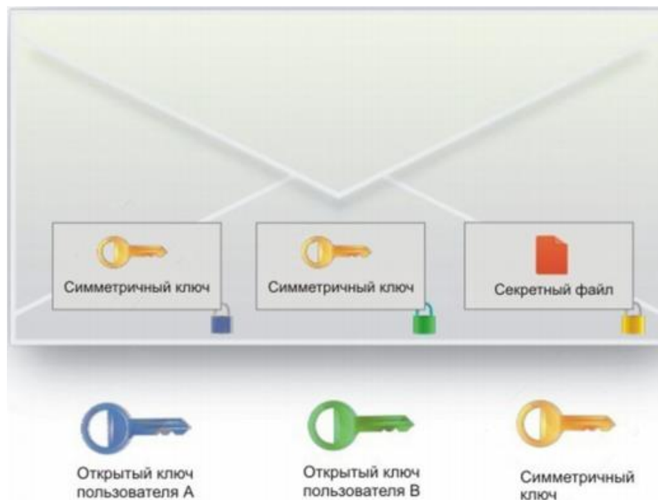
Рисунок 1.9 – Схема прозорого шифрування
