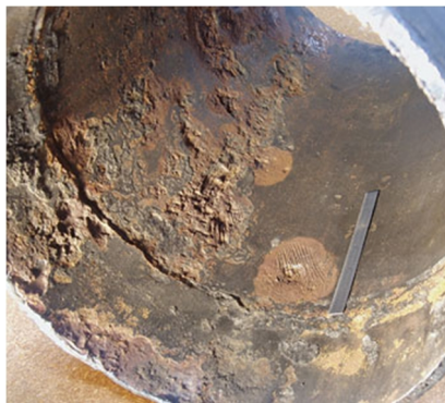
Рис. 1. Корозійні пошкодження внутрішньої поверхні газопроводу, спричинені дією рідини, яка збирається в його порожнині.
