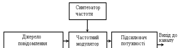
Рисунок 3 - Структурна схема формувача FM сигналів
