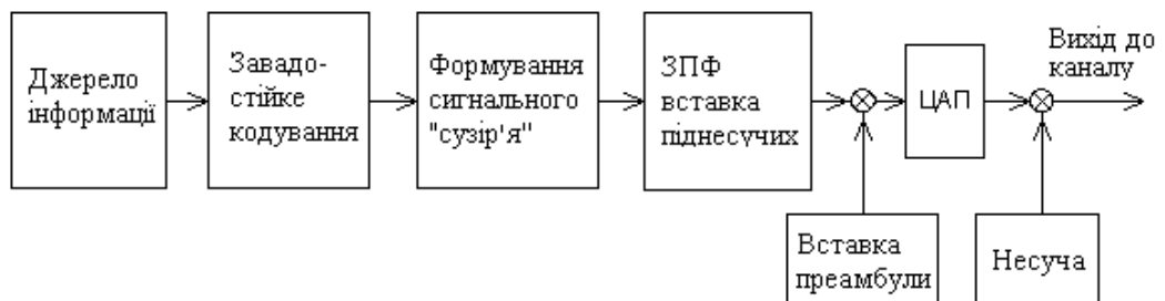
Рисунок 9 - Структурна схема формувача MultiBand OFDM UWB сигналів
