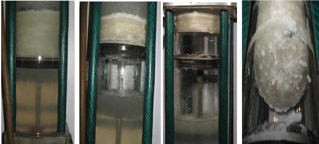
Рис. 2. Етапи процесу сепарації газогідратної маси
