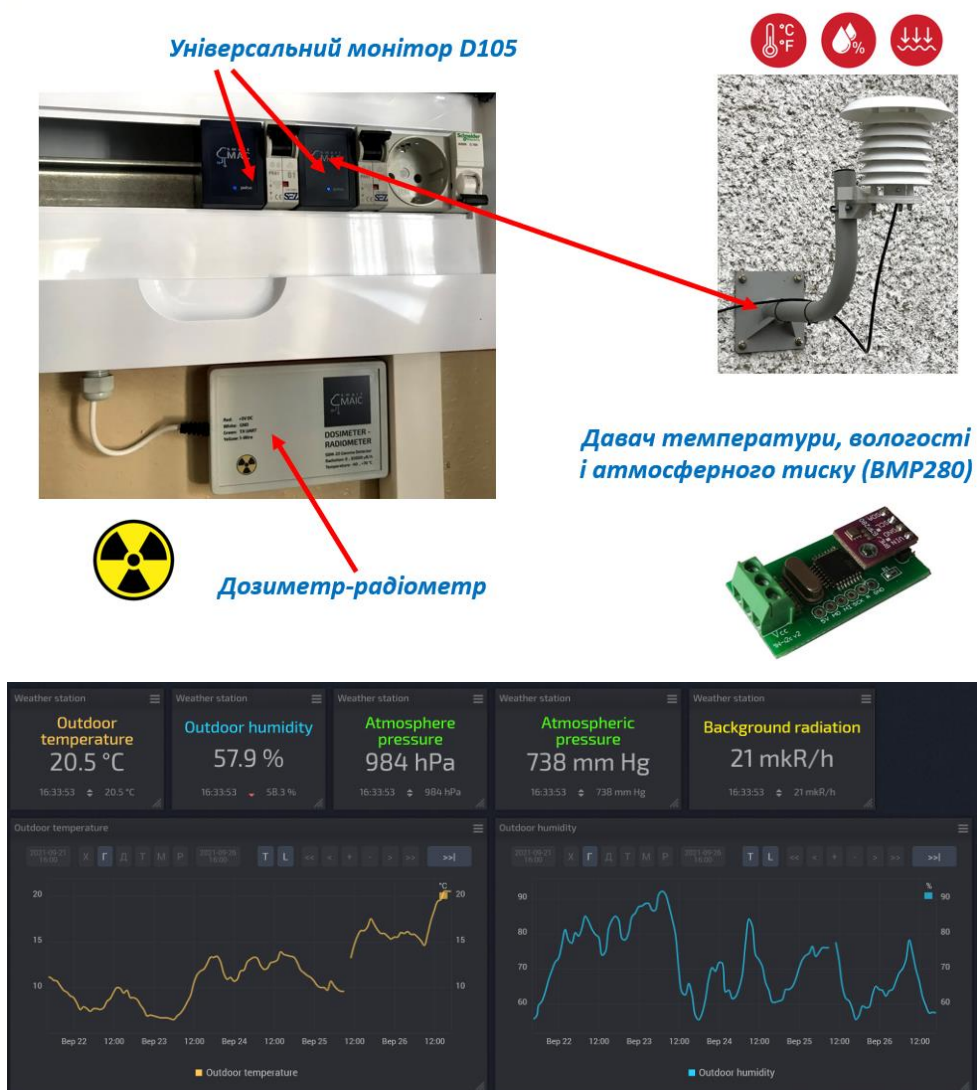
Рисунок 8 – Реалізація частини метеорологічного модуля системи енергетичного моніторингу будівлі, що призначений для реєстрації температури та вологості зовнішнього повітря і значення атмосферного тиску
