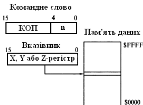
Рисунок 3.5 – Непряма адресація пам'яті даних з використанням регістрів X, Y, Z
