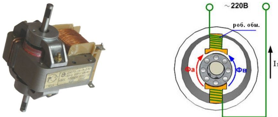
Рисунок 15.9 – Однофазний асинхронний двигун з короткозамкненим ротором
