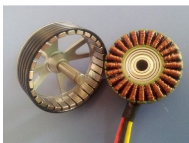
Рисунок 15.4 – Безколекторний електродвигун постійного струму із зовнішнім якорем
