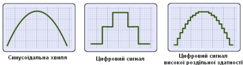
Рисунок 15.22 – Форми сигналу обмоток при мікрокроковому керуванні
