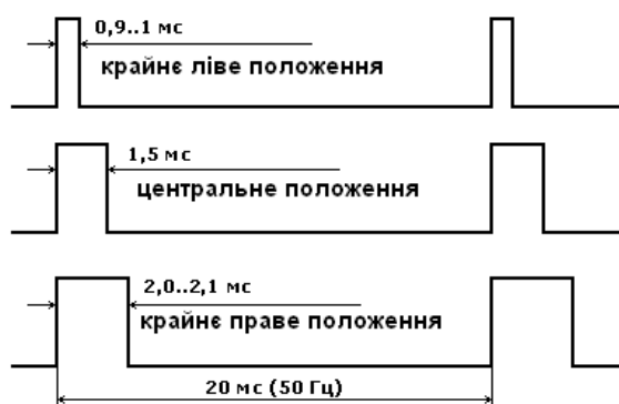
Рисунок 15.14 – Керуючі сигнали сервоприводу
