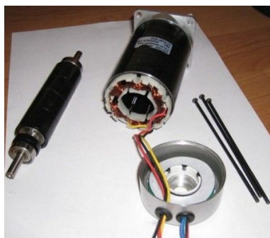
Рисунок 15.3 – Безколекторний електродвигун постійного струму з внутрішнім якорем
