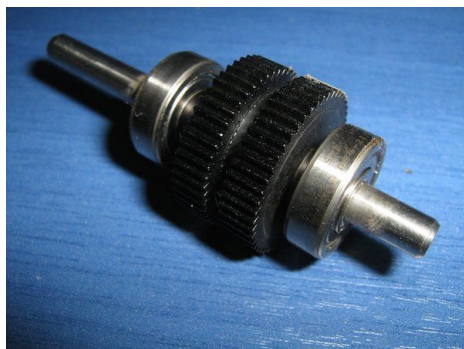
Рисунок 15.26 – Ротор з двома 50-зубими дисками
