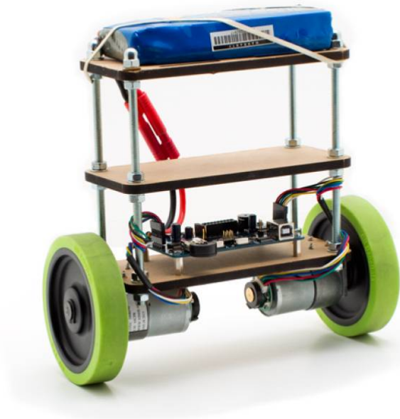
Рисунок 2.3 – Балансуючий робот з відкритим кодом Balduino створений TKJ Electronics
