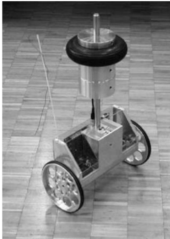
Рисунок 1.3 - Міні-прототип транспортного засобу для перевезення людей JOE
