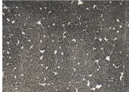
Рис. 5. Мікрофотографія півки германіда заліза, конденсованої при малих термодинамічних пересиченнях на скол NaCl при T_p=680 \text{ K} (h = 80 нм) (x10000).
