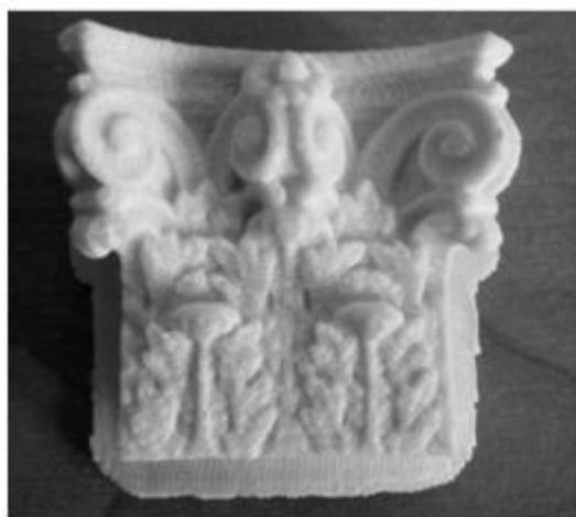
Рис.5. 3D модель капітелі виконаний на 3D принтері макетної лабараторії AXI ОДАБА компанії Prototek Італія.
