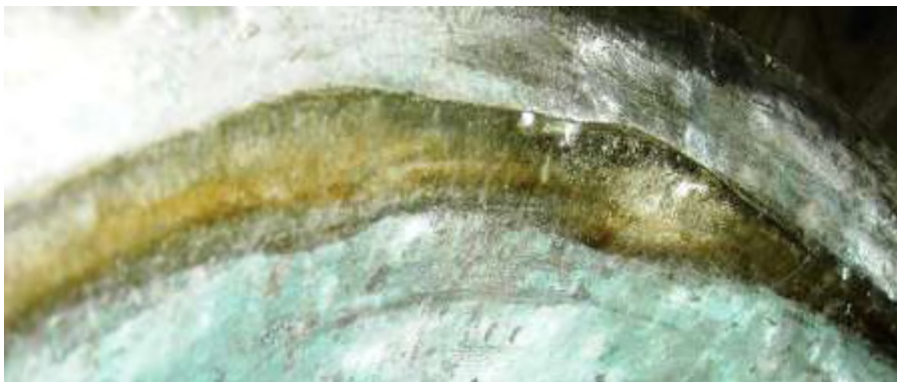
Сліди зносу від ударів язиком на важчому дзвоні
