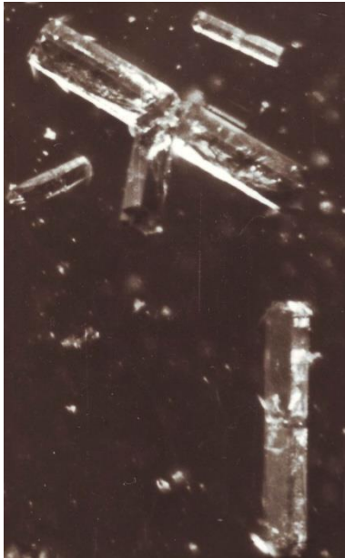
Рис. 1. Фотографія кристалів нітриду галію, отримана при збільшенні \times 20 .
