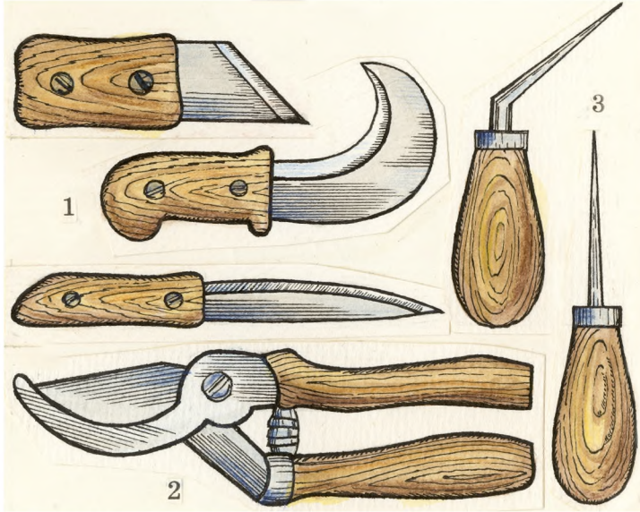
Рис. 3.7. Інструменти та пристрої, що використовуються в лозоплетінні: 1 – ножі; 2 – сикатор; 3 – шила.
