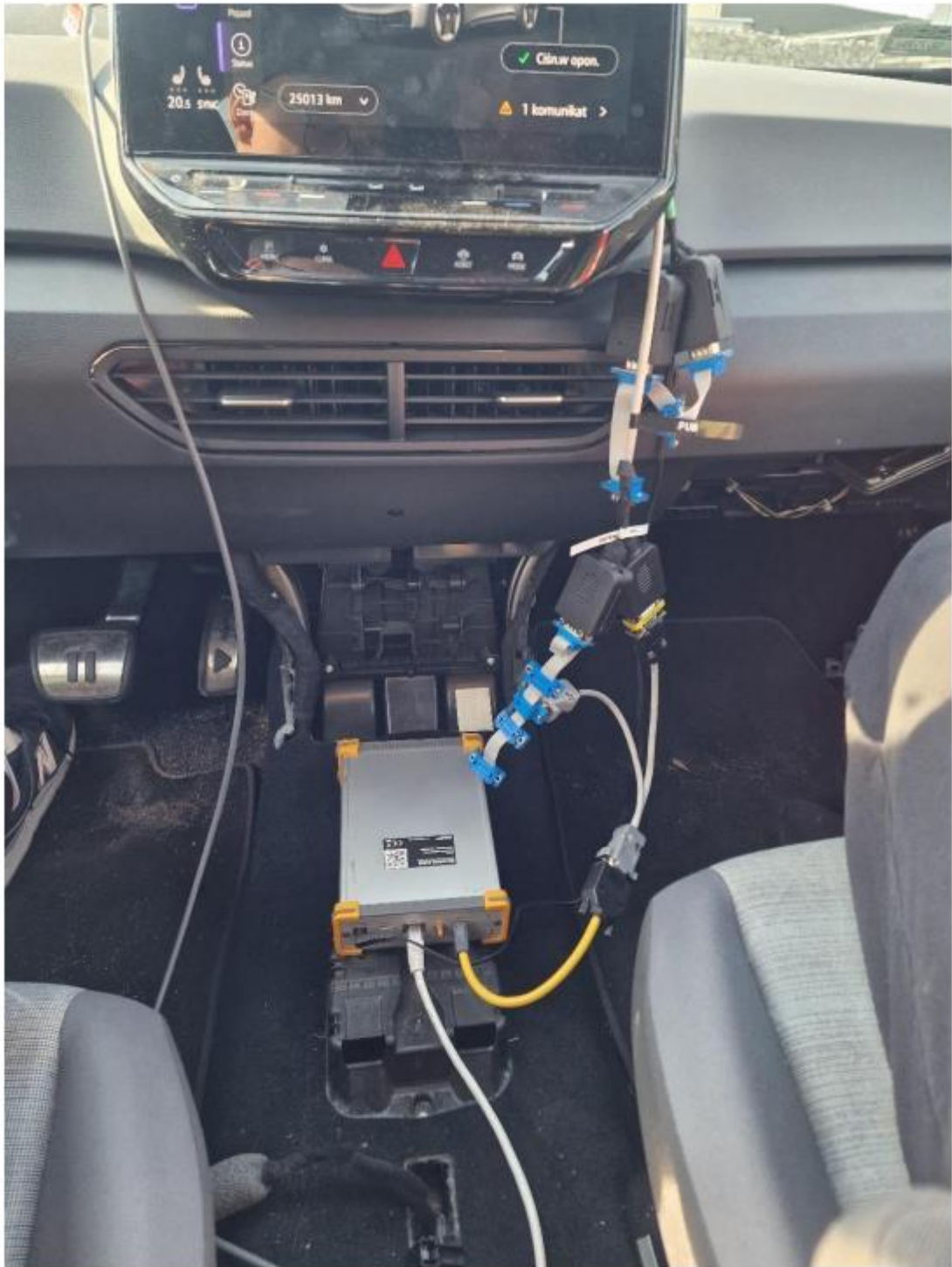
Рис.3.13. Реальний автомобільний пристрій Microdaq E2000 як міст, підключений до шини CAN
