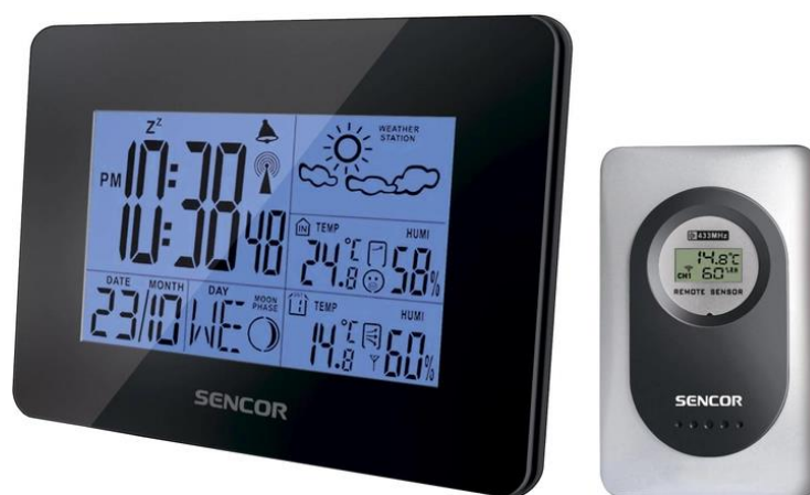
Рис. 1.1. Зовнішній вигляд Sencor SWS 51 B (зліва) та безпроводного датчика (справа).
