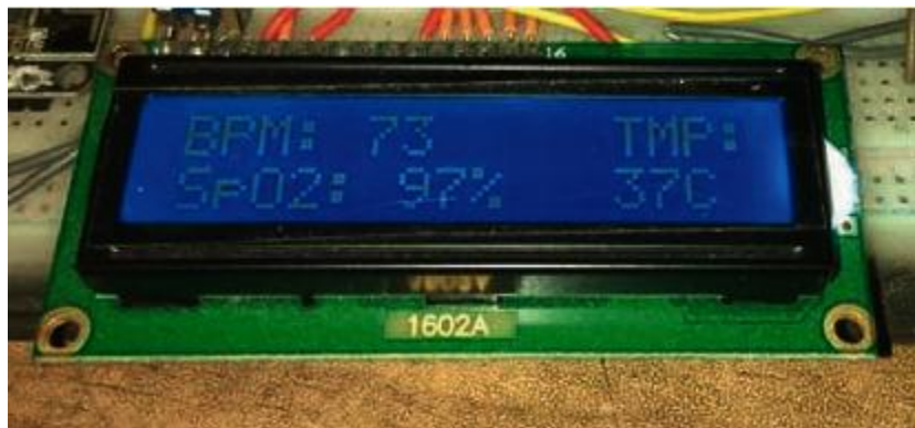
Рисунок 5.6. Прототип рідкокристалічного дисплея 16 × 2
