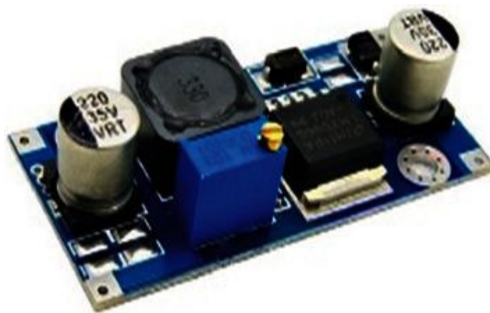
Рисунок 5.5. Прототип понижувального конвертера
