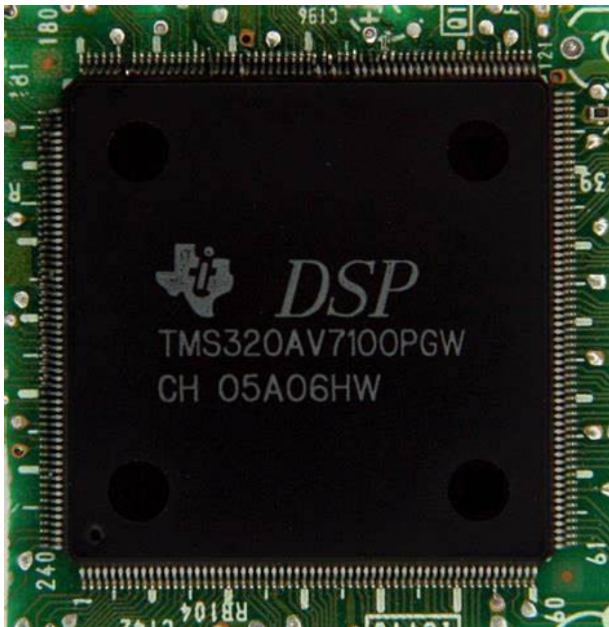
Рисунок 2.1. Процесор TMS320 від компанії Texas Instruments спеціально призначений для цифрової обробки сигналів
