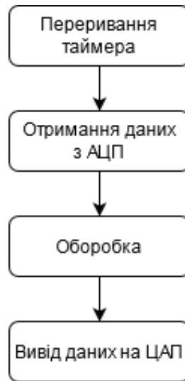
Рис. 3.9 Діаграма загального алгоритму роботи пристрою.
