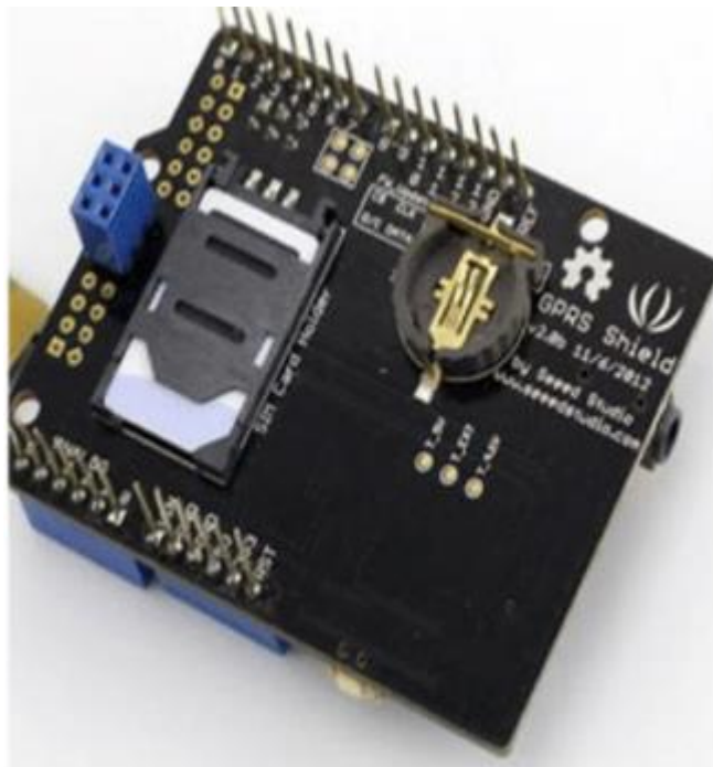
Рисунок 4.2. Вигляд спереду модуля GSM із зазначенням гнізда SIM-картки
