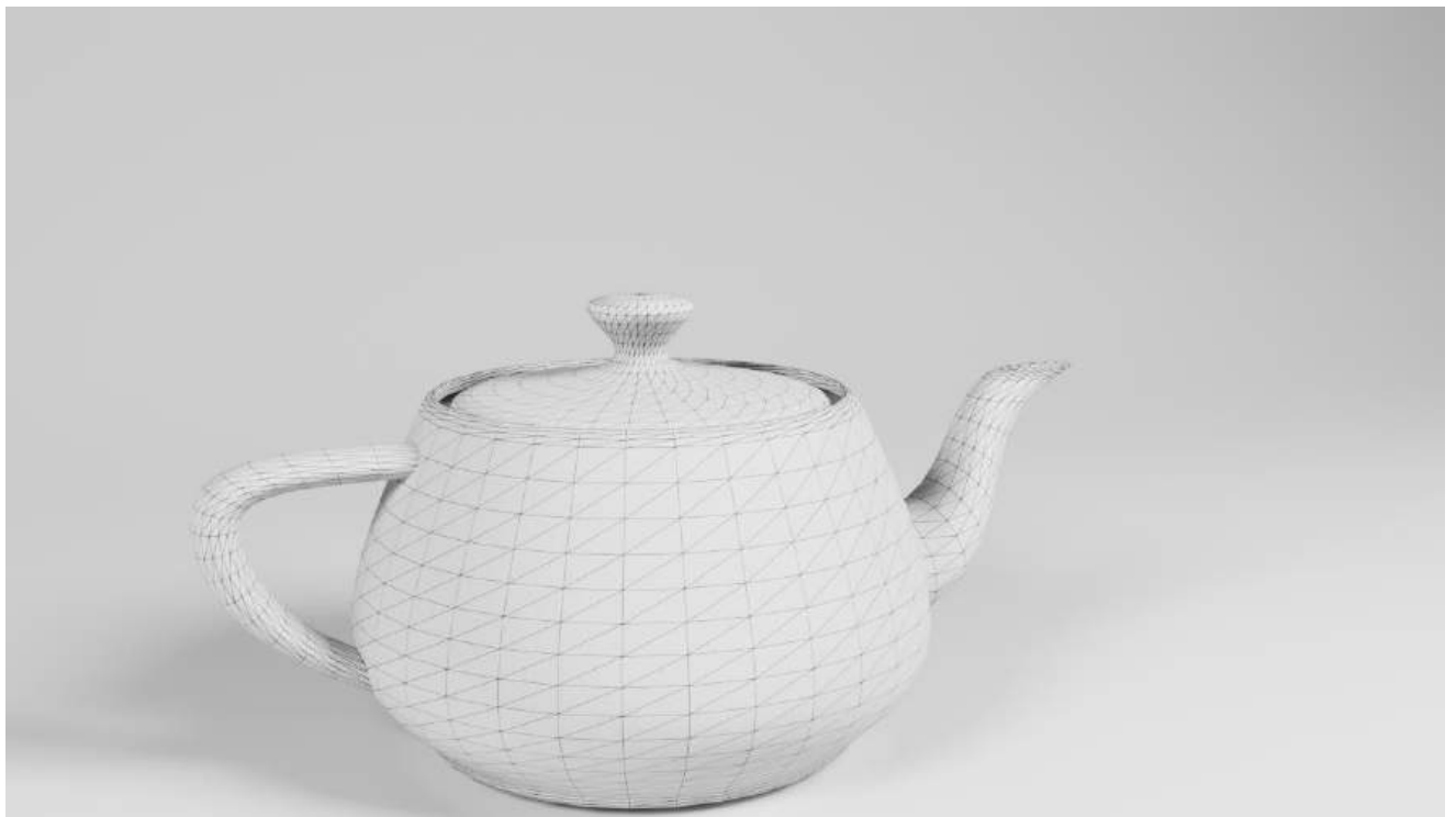
Рисунок 1.2 – Візуалізація сітки трикутників 3D моделі.
