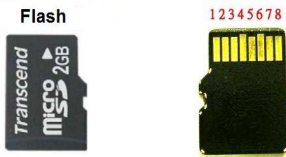
Рис. 2.7. Зовнішній вигляд карти пам'яті та нумерація контактів.
