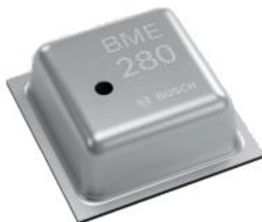
Рисунок 2.4. Зовнішній вигляд датчика BME280
