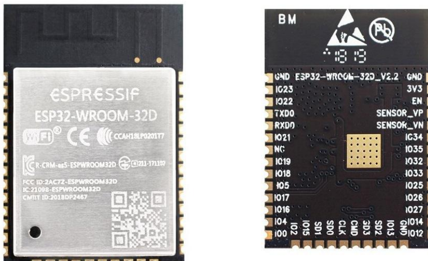
Рисунок 2.1. Зовнішній вигляд ESP32
