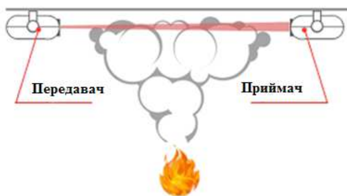
Рис. 1.2. Забраження роботи лінійного димового сповіщувача.
